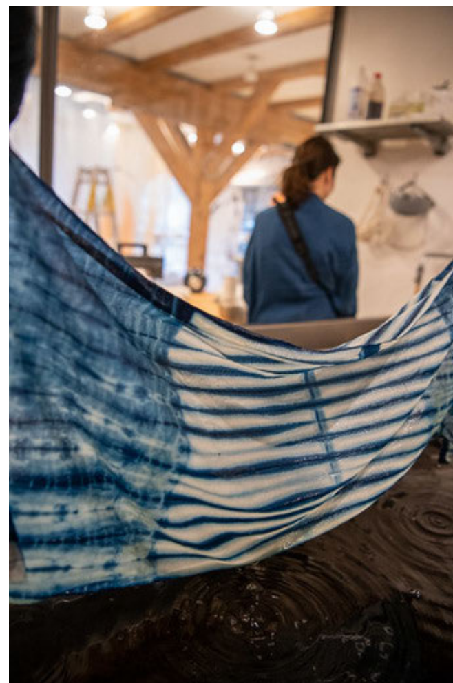
PROCES. Danmark har planten vajd med det pigment, der skaber farven blå. Før det kan indfarve stof, skal det dog gøres opløseligt via fermentering eller kemi. Foto: Sven Bloch
